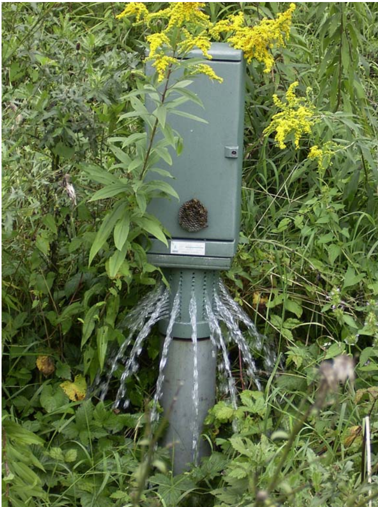
Abb.21: Überflutete Grundwassermessstelle im Amtsbereich des WWA Freising infolge hochwasserbedingter artesisch gespannter Verhältnisse
